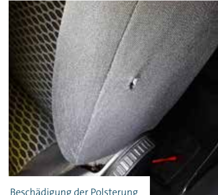
Beschädigung der Polsterung
